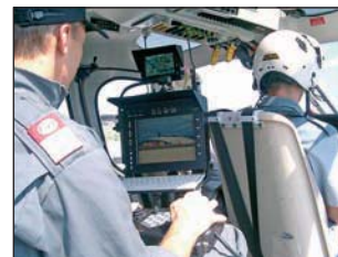
Besatzung arbeitet mit schwenkbarem Observer LCD-Monitor. Umschaltbar auf FLIR-IGPS-Bild.
